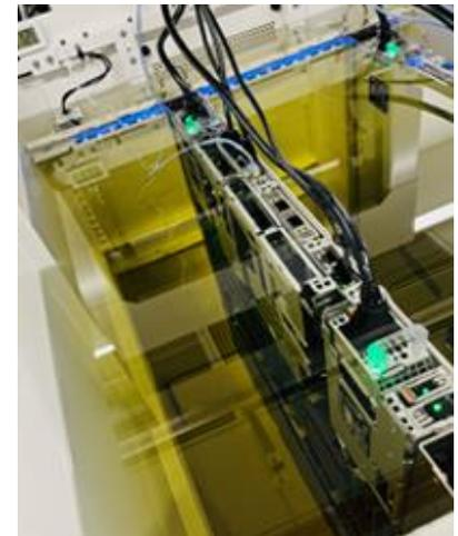
専用オイルに浸かり、液浸冷却中のサーバー
